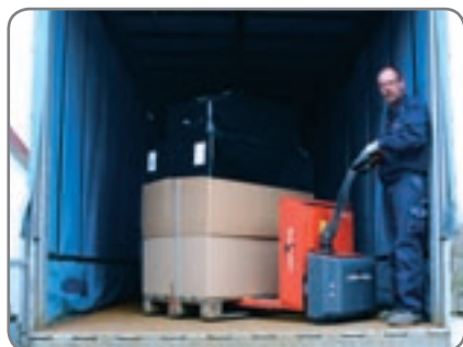
Panther Maxi (Tragkraft 1800 kg) wird für schweren Palettentransport, z.B. für Speditionen, empfohlen.
