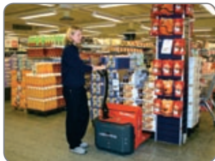
Panther Mini (Tragkraft 1400 kg) wird für leichten Paletten-transport, z.B. in Supermärkten und in Lägern, empfohlen.
