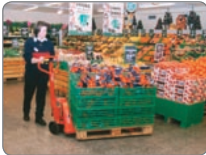
Einstellbare Einfahrhöhe - keine Probleme mit niedrigen und abgenutzten Paletten.
