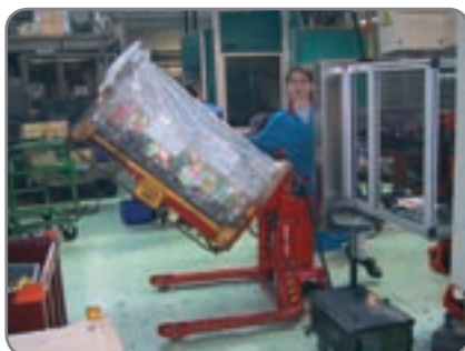
Das Breitspurfahrwerk ermöglicht das Handeln geschlossener Paletten. Hier bei der Komponentenherstellung.
