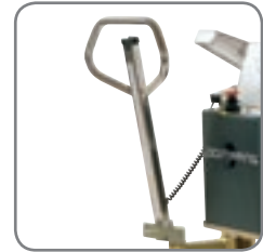
Die Deichsel kann gedreht und festgestellt werden. Der Anwender hat freien Zugang zum Inhalt der Gitterbox oder des Kastens.
