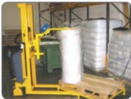
Der Rollenkipper - eine gute Alternative beim Heben und Kippen von Rollen.
