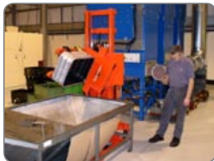
Boxhalter für Kistenbreiten bis zu 1400 mm sind als Sonderlösung erhältlich.
