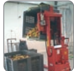
Die Seitenkippgabeln hier beim Entleeren des Boxeninhalts von einer Box in eine andere.
