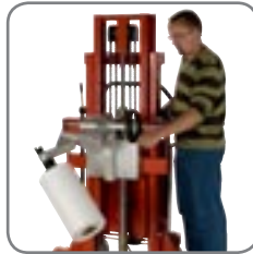
Die Drehfunktion ist manuell, mit oder ohne Getriebe.
