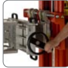
Die Rolle ist durch den Spindelhandgriff festzuspannen.
