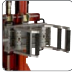
Die Standard-Greifarme sind für Papierrollen berechnet. Fragen Sie bitte bei anderen Rollentypen, z.B. Kunststoffrollen.
