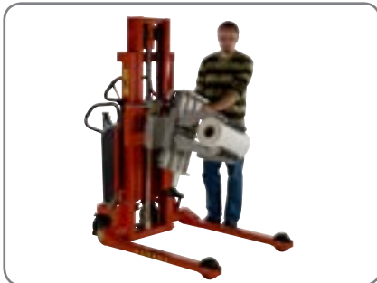
Die Drehfunktion ist manuell, und die Rolle kann in vier Positionen festgestellt werden.
