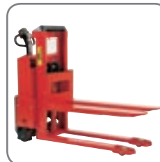
Ohne Breitspurfahrwerk: Unterfahrmöglichkeit notwendig.
