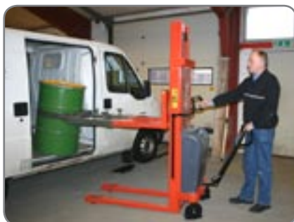
Der Fasseheber hebt hier ein Fass und platziert es in einem Lieferwagen.
