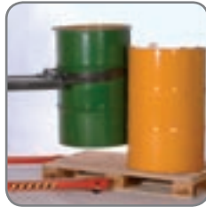
Sehr flexible Handlingsituation, da die Fässer von verschiedenen Einfahrwinkeln gegriffen werden können.
