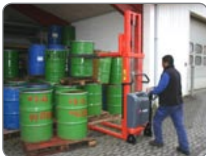
Der Fasseheber ist hier an einen Logiflex mit festem Gabelträger angebaut.
