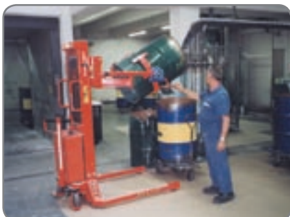
Der manuelle Fasskipper für alle Logiflex-Modelle. Der elektrische Fasskipper nur für die elektrischen Logiflex-Modelle.
