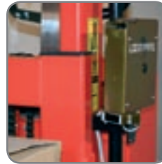
Durch einen optischen Sensor hebt sich die Gabel beim Entladen und senkt sich beim Beladen.
