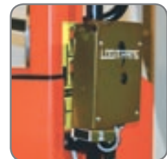
Sensor mit einstellbarer Zeitverzögerung: 1-10 Sek.
