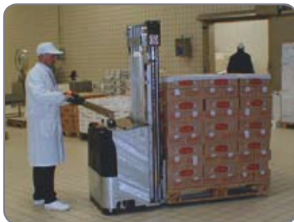
Optimale Sicherheit: u.a. schlagfeste Scheibe und herabgesetzte Fahrgeschwindigkeit in gehobener Stellung.
