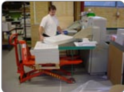
1500 kg können transportiert und bis auf 400 mm angehoben werden. Ab 400 mm Hub ist die Tragkraft 1000 kg.
