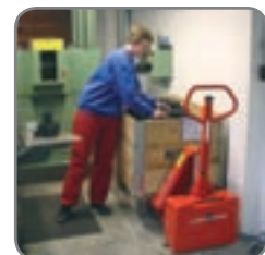
Patentierter Zylinder-Konstruktion ergibt eine niedrige Bauhöhe.
