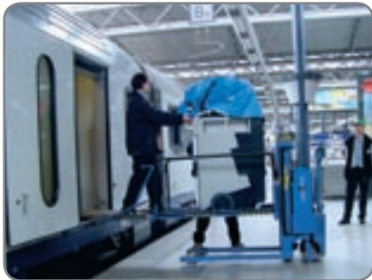
Logiflex mit Plattform und klappbarer Brücke zum Austausch von Servierwagen in Zügen.
